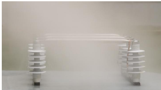
Model podczas badań laboratoryjnych – aplikacja środków gaśniczych bezpośrednio na elementy znajdujących się pod napięciem
