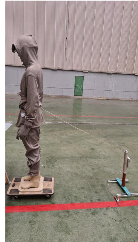
Pomiar napięć krokowych
