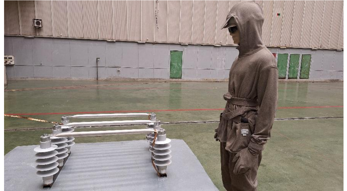
Manekin ubrany w przewodzący strój i ustawiony w strefie oddziaływania pola elektrycznego
