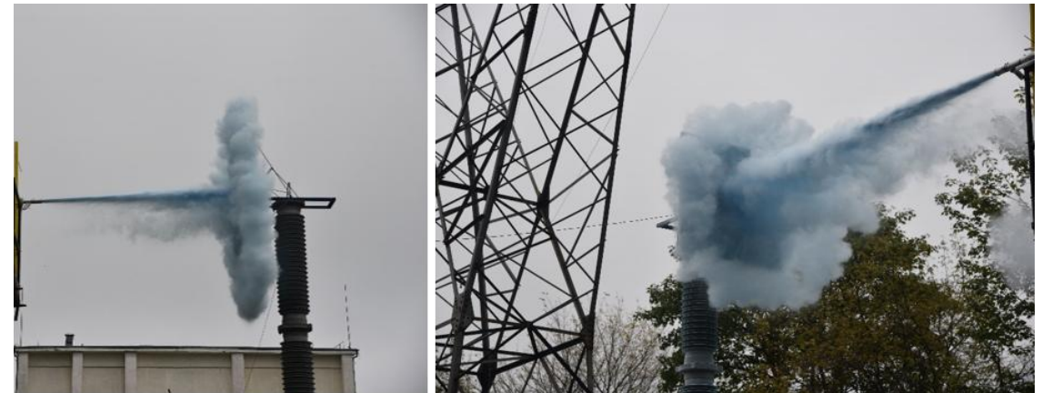
Proszkowy agregat gaśniczy podczas badań wytrzymałości na przebicie
